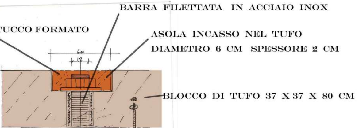
COPERTURA DEL BULLONE CON STUCCO FORMATO DA POLVERE DI TUFO E RESINA
