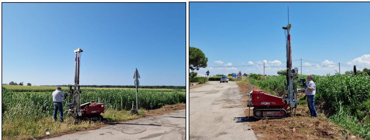
Realizzazione sondaggi penetrometrici S1 (sx) e S2 (dx)
